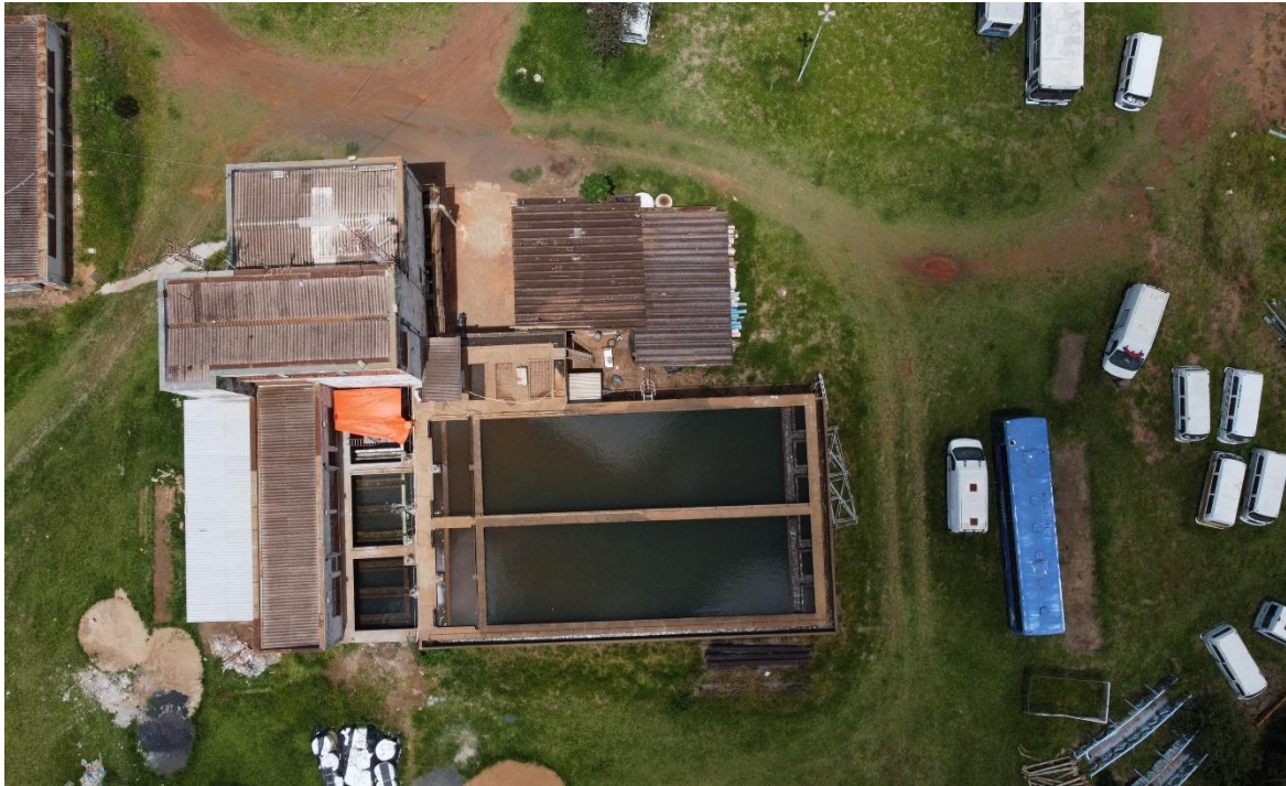
Figura 20 - Vista aérea dos decantadores.
